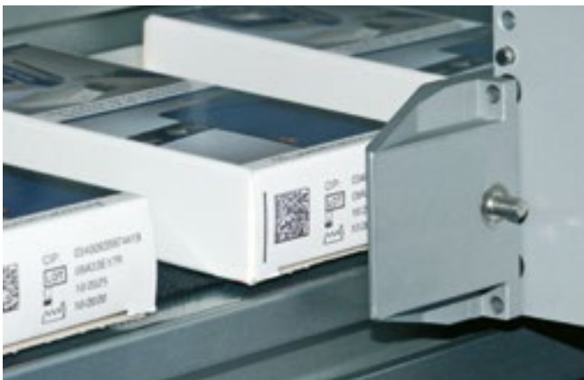
Faltschachtelkennzeichnung mit Data Matrix Code
