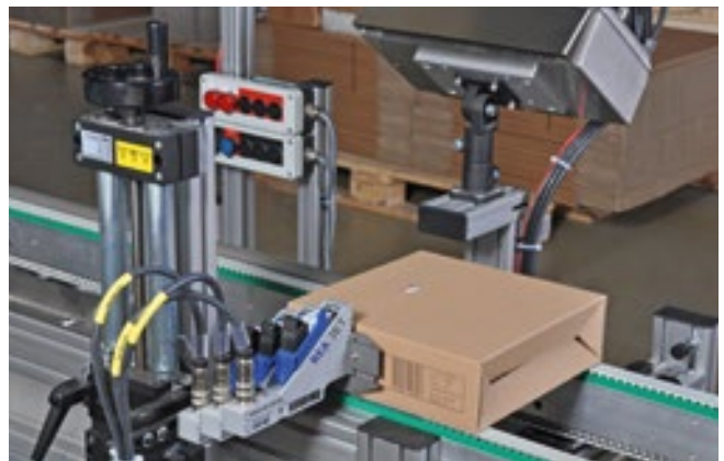
Etiketteneinsparung durch HR Direktdruck auf Kartons
