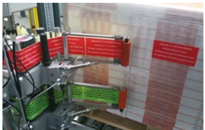
Applizieren von Etiketten auf Schrumpfhäuben
