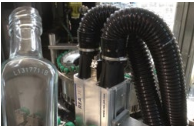
Glaskennzeichnung mit CO 2 Laser IP65
