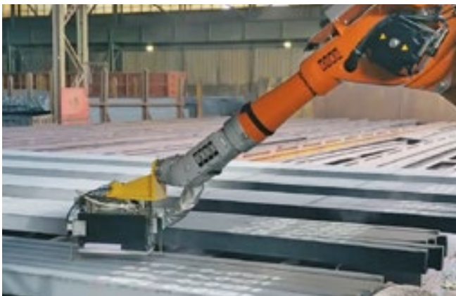
Stahlknüppelmarkierung Signierblock an Roboter
