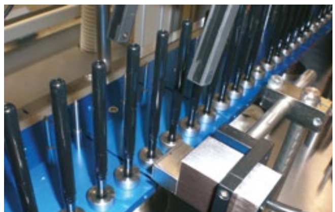
Punktgenauer Ölauftrag auf Kunststoffteile
