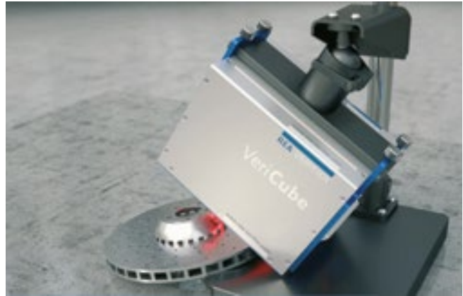
Stativlösung zur Codeprüfung auf 3D Komponenten
