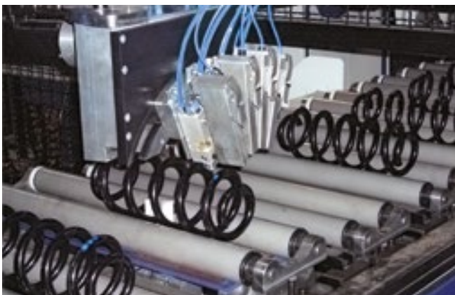
Kennzeichnung von Stahlfedern zur Typenklassifizierung
