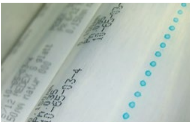
Kontrolllinie auf PE-Folienschlauch
