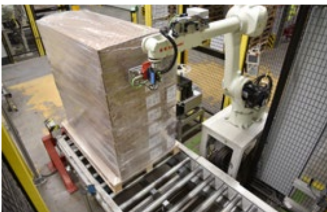
Roboter Etikettierung von Paletten
